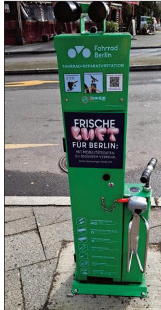
*Luftdruck-Prüfer und einfaches Werkzeug für die Fahrradreparatur findet man an der Station.*
