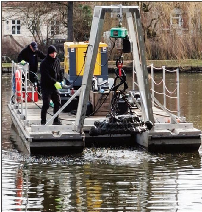
Der Dorfteich wird mithilfe eines großen Magneten von Schrott gereinigt.
