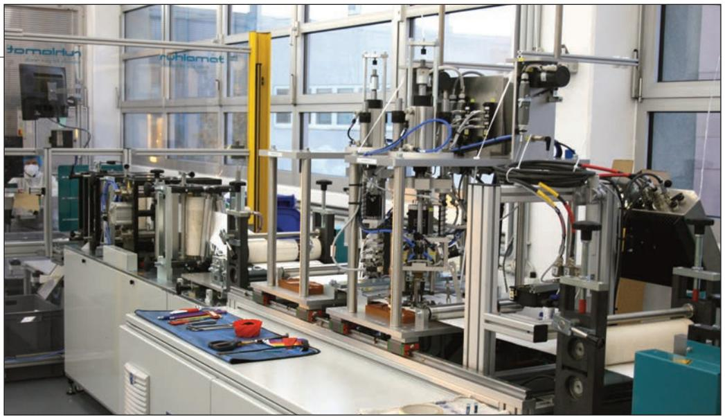
An dieser Maschine werden die Masken aus Vliesstoff hergestellt. Pro Minute schafft sie 40 Stück. An fünf Tagen der Woche wird rund um die Uhr produziert.
